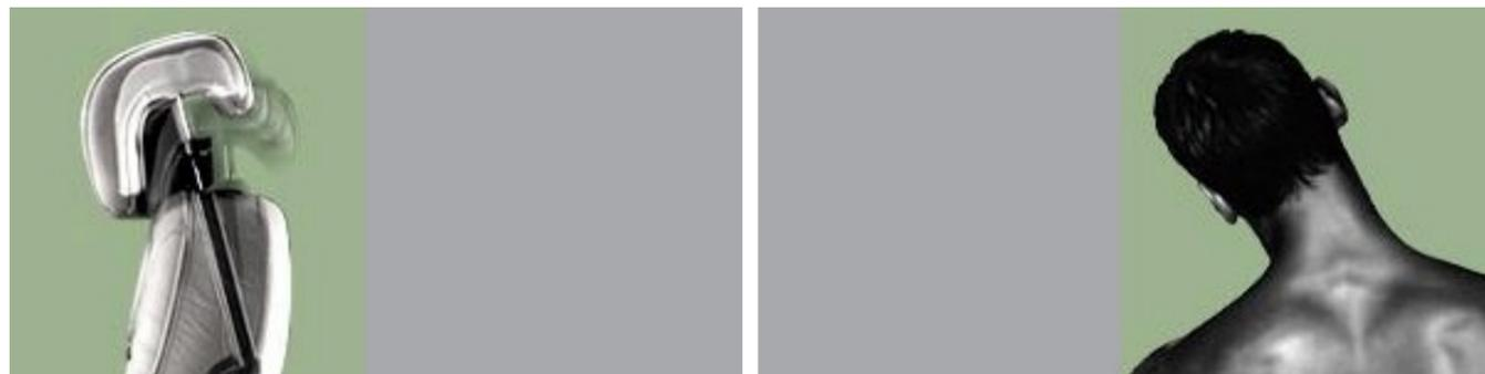
Saab présente l'appuie-tête actif SAHR, une première dans l'industrie. Lors d'une collision arrière, un bras incorporé au siège fait remonter l'appuie tête, retenant la tête lorsqu'elle est renvoyée vers l'arrière et réduisant les risques de coup de fouet cervical.
