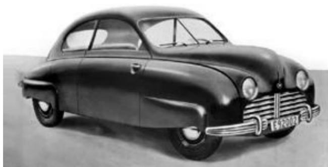
**Le premier prototype Saab est un modèle à traction muni d'un moteur transversal, des décennies avant que cette configuration soit en vogue.**
