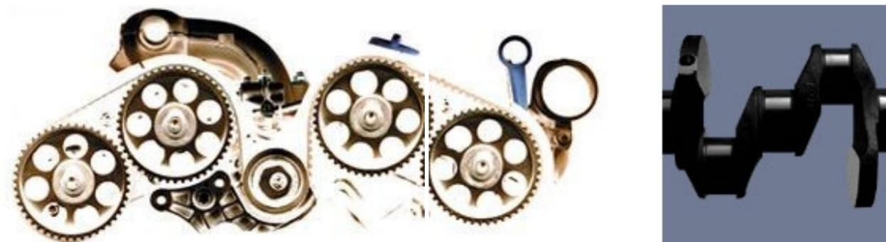
Saab lance un V6 à turbocompresseur asymétrique. Ce dernier est mû par trois des cylindres du V6 et suralimente tous les cylindres du moteur.
