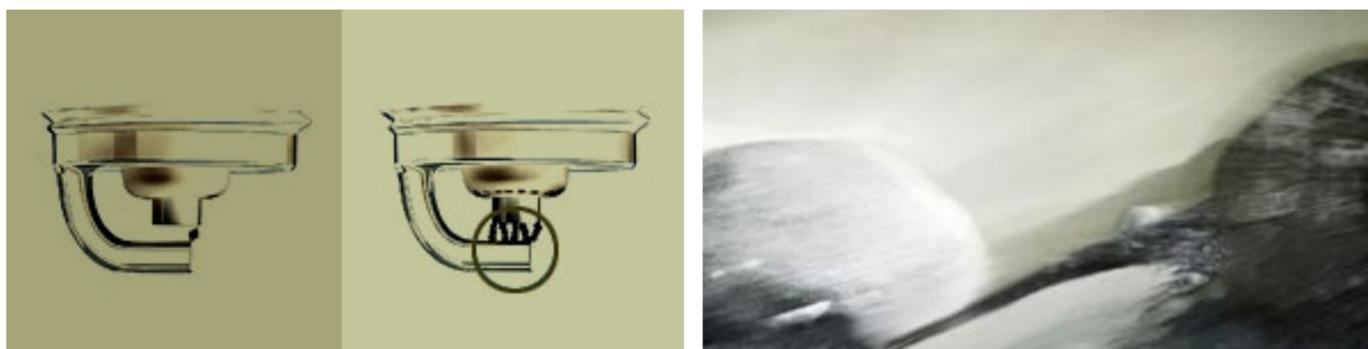
Saab lance l'allumage direct, qui permet d'éliminer le distributeur et les fils haute tension. C'est une bobine haute tension montée sur chaque bougie qui permet de produire l'étincelle. Le système garantit des démarrages sûrs, peu importe les conditions météorologiques.
